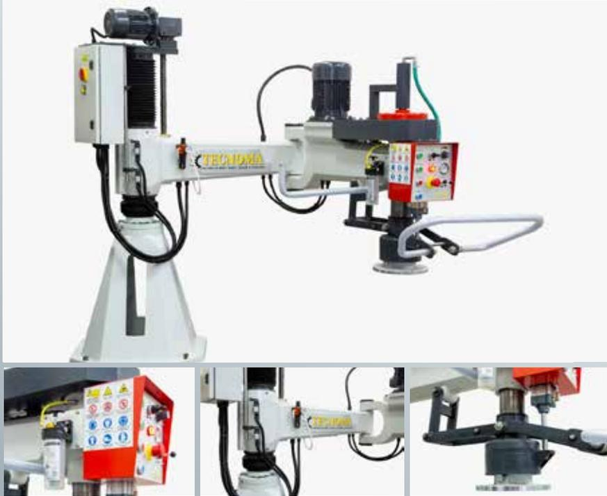
Macchina lucidatrice a colonna a due velocità, con salita e discesa elettriche. Impianto con pistone pneumatico e regolazione di pressione per lucidatura marmo e granito, oppure per spazzolare o rotobocciardare con piatto.
