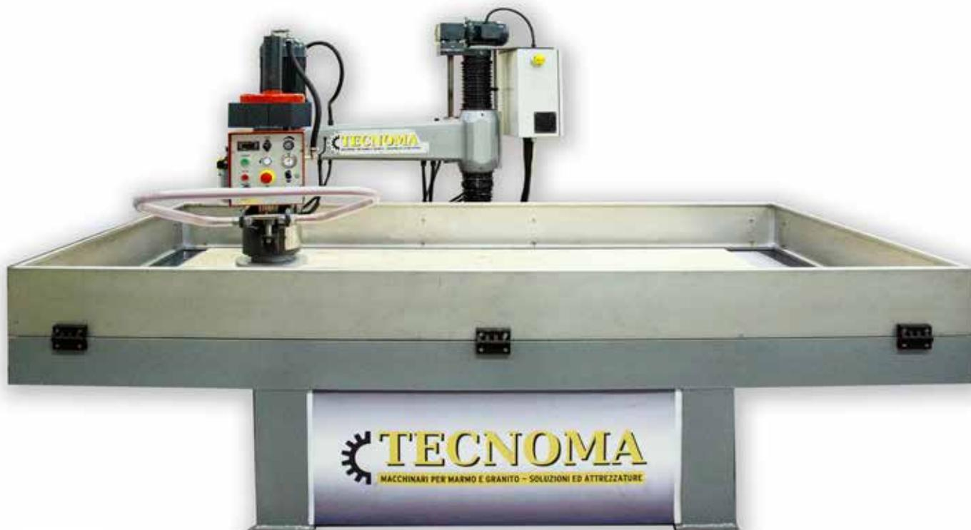
Macchina lucidatrice a colonna a due velocità, con salita e discesa elettriche. Impianto con pistone pneumatico e regolazione di pressione per lucidatura marmo e granito, oppure per spazzolare o rotobocciardare con piatto.
